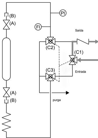
O sistema GSP tem como características, segurança e simplicidade operacional, pois toda operação é feita através de uma única alavanca. O sistema possui saída para alívio e purga, o que garante a representatividade da amostra e a despressurização do sistema. O cilindro de amostragem é acoplado ao sistema por intermédio de engates rápidos de alta performance, os quais facilitam a operação e impedem possíveis emissões fugitivas de gás.
